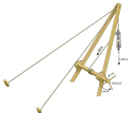
ปั้นจั่นของชาวโรมันที่มีพื้นฐานมาจากเทคโนโลยีของอารยธรรมกรีก (ภาพจาก en.wikipedia.org/wiki/Ancient_Greek_technology )
