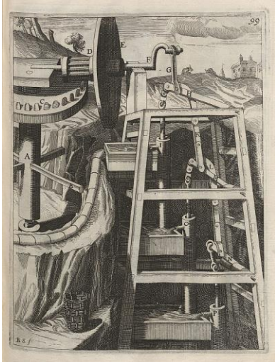
ปั้มน้ำที่ใช้กลไกข้อเหวี่ยงและก้านสูบที่ก้วหน้า จากภาพวาดของ Georg Andreas Böckler ปี ค.ศ. 1661 (ภาพจาก en.wikipedia.org/wiki/Renaissance_technology )
