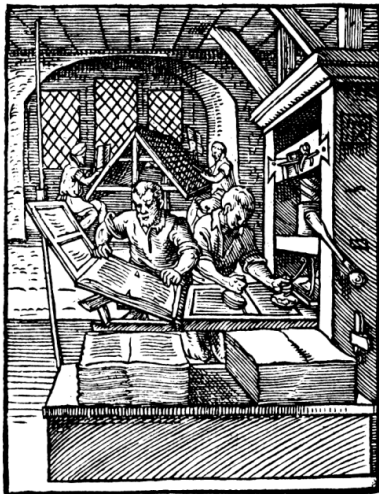
เครื่องพิมพ์ในช่วงปลายยุคของยุโรปสมัยกลางที่มีความสามารถในการพิมพ์ได้กว่า 3600 หน้าต่อวัน (ภาพจาก en.wikipedia.org/wiki/Printing_press )
